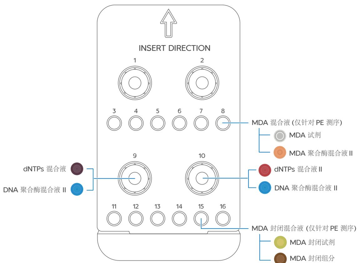
图 17 试剂槽孔位信息示意图
