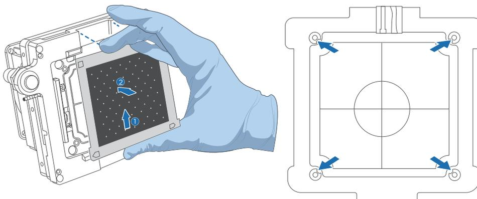
图 9 载片放置和密封垫示意图
