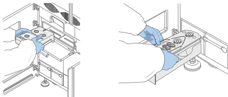
图 22 测序试剂槽和清洗试剂槽放置
