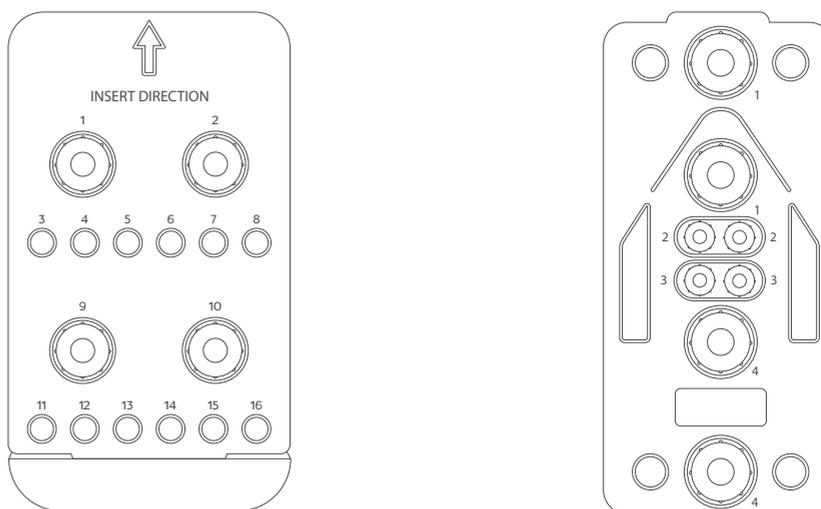
图 35 空 T7测序试剂槽和空 T7清洗试剂槽
